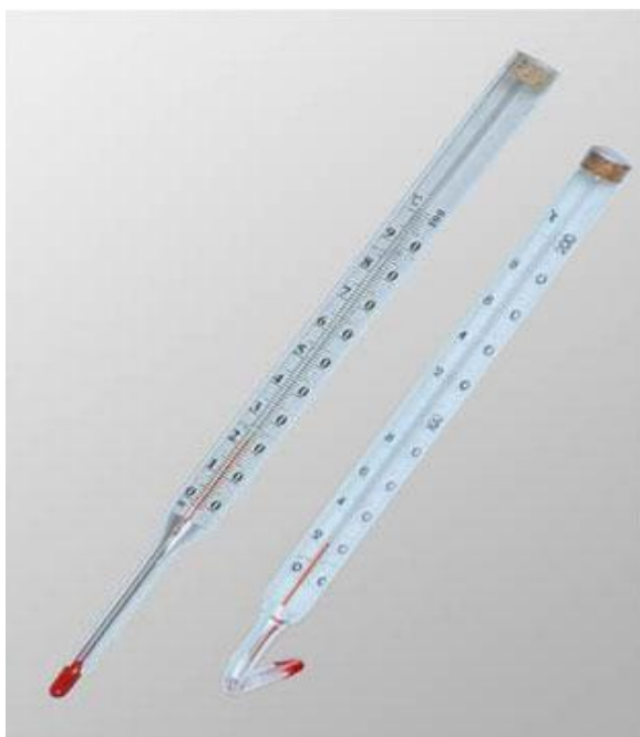
Рисунок 1 - Общий вид термометров стеклянных керосиновых СП-2
